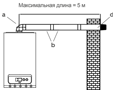
Рисунок 15 Монтаж дымохода с одним угловым отводом 90°.
