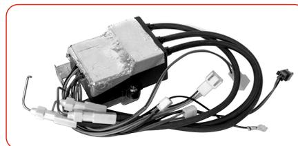
ности водонагревателя или появления нарушений в его работе. Питание: от батарейки 3 В. Устройство розжига начинает работу одновременно с моментом подачи газа на горелку и продолжает работать до поступления сигнала о наличии пламени на горелке.
