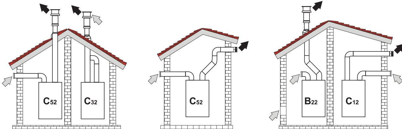
рис. 18 - Примеры подсоединения с помощью раздельных труб (➡ = Воздух / ➡ = Продукты сгорания)
