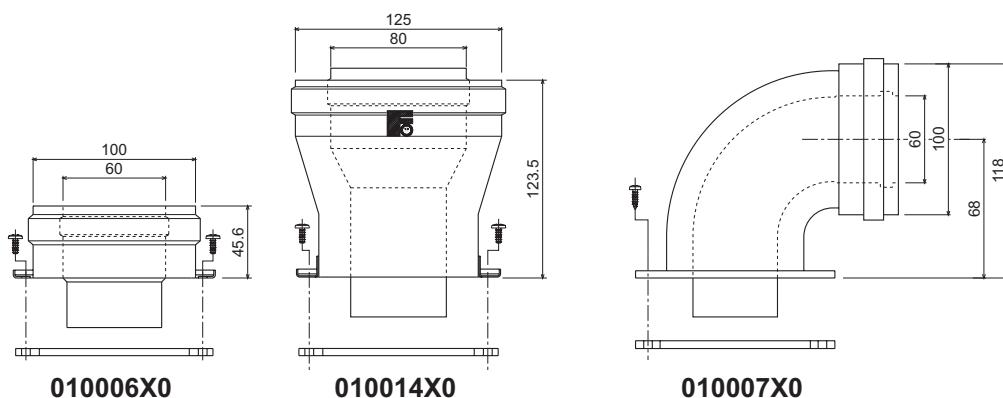
рис. 17 - Исходные элементы для коаксиальных воздуховодов
