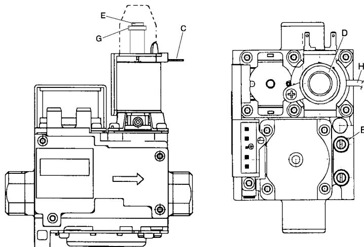
рис. 22 - Газовый клапан
