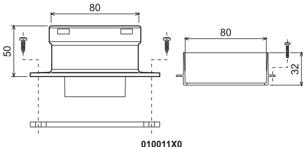
рис. 19 - Соединительный элемент для раздельных труб
