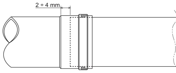
рис. 14 - Термовое расширение
