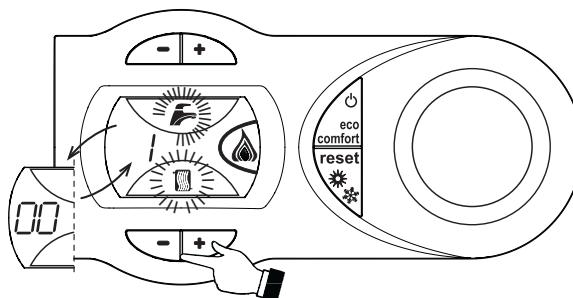
рис. 21 - Режим TEST (мощность системы отопления = 100%)
