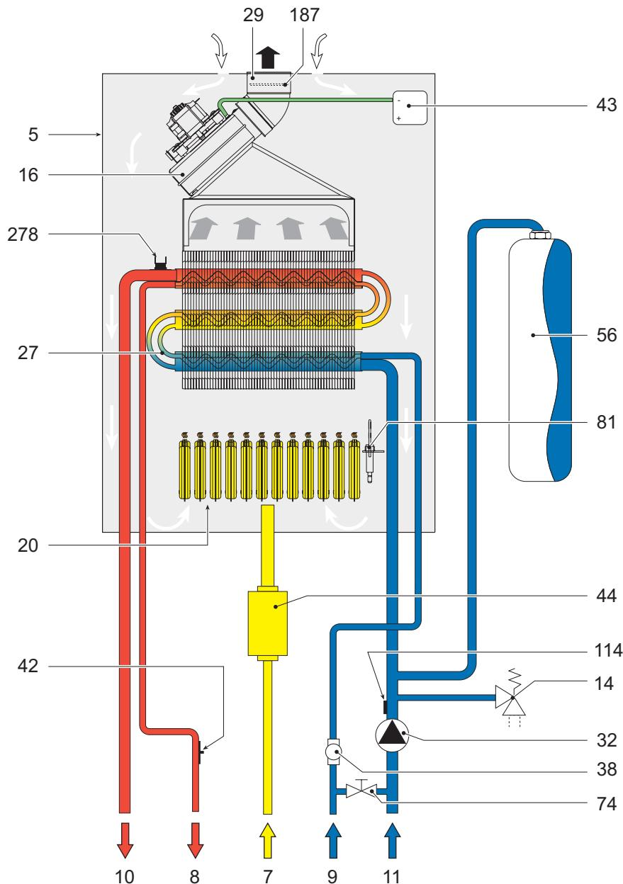
рис. 27 - Схема системы отопления и контура ГВС
