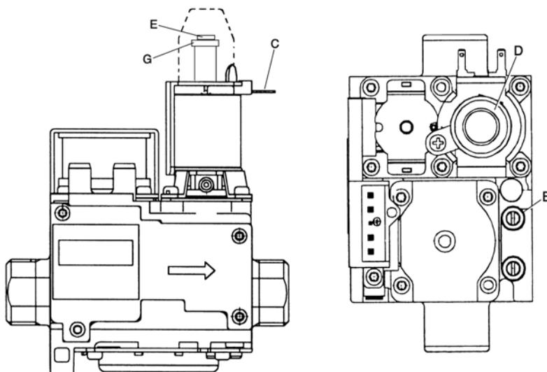
рис. 15 - Газовый клапан
