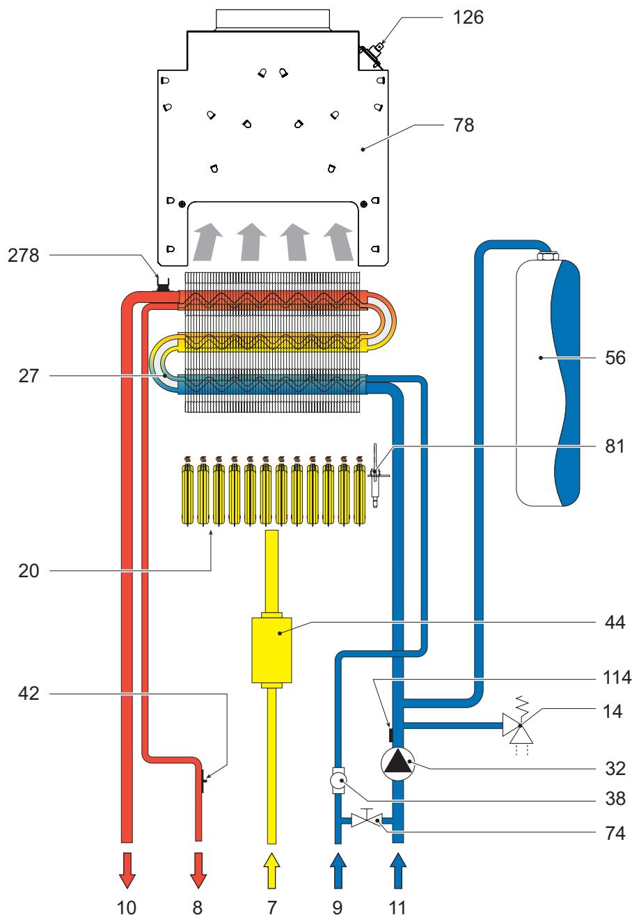
рис. 19 - Схема системы отопления и контура ГВС
