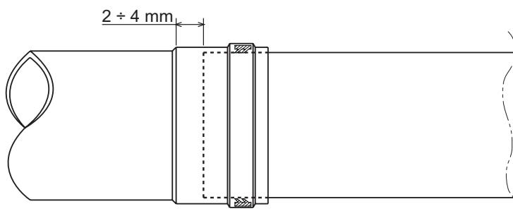
рис. 20 - Тепловое расширение
