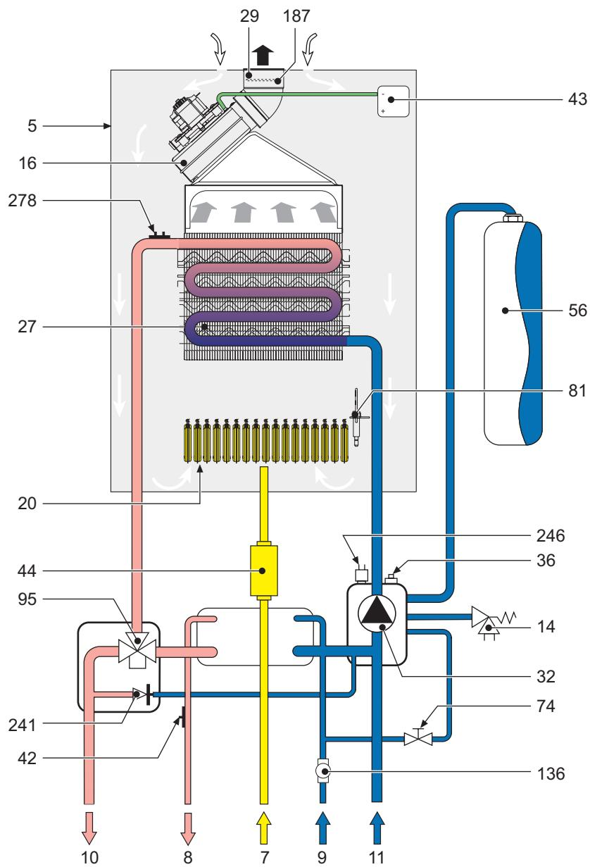
рис. 33 - Схема системы отопления и контура ГВС
