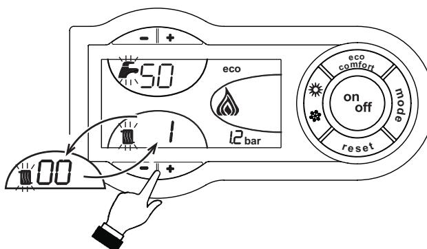
рис. 27 - Режим TEST (мощность отопления = 100%)
