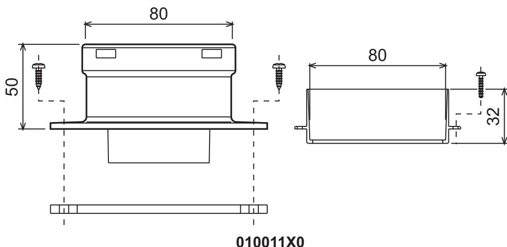
рис. 25 - Соединительный элемент для раздельных труб
