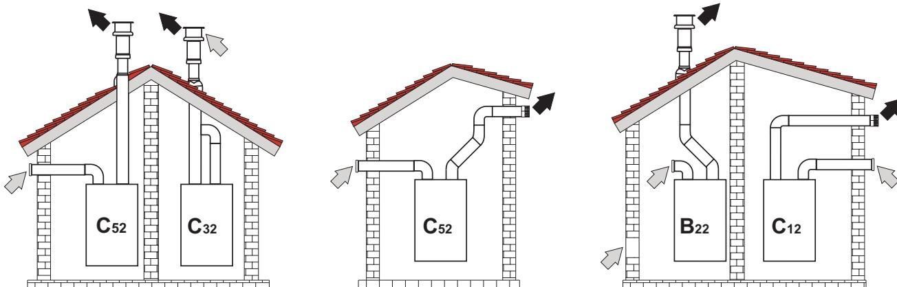
рис. 24 - Примеры подсоединения с помощью раздельных труб (➡ = Воздух / ➡ = Продукты сгорания)
