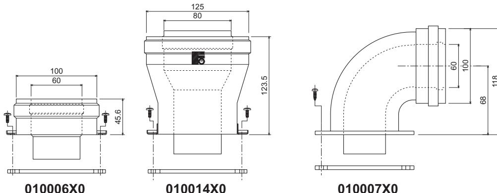
рис. 23 - Исходные элементы для коаксиальных воздуховодов
