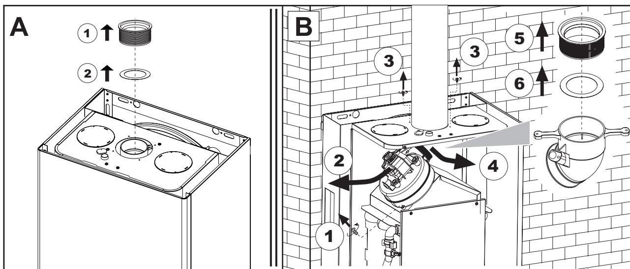
рис. 21 - Замена диафрагмы (A = если котел не установлен / B = Если котел и воздуховоды уже смонтированы)
